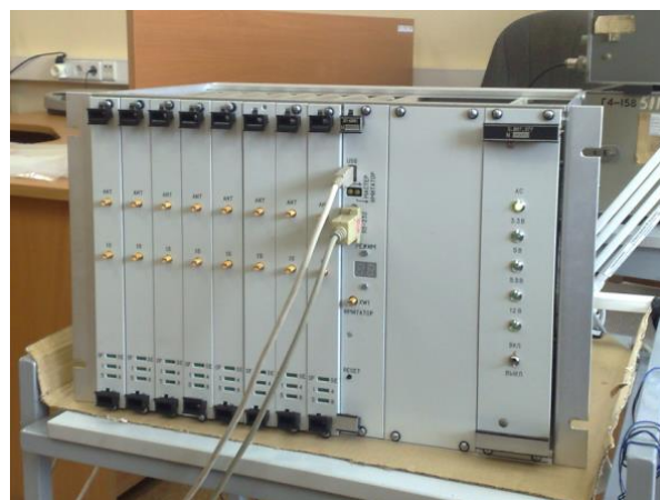
Рис. 3. Внешний вид крейта 32-канального приемного устройства ионозонда «Авгур-Д».
