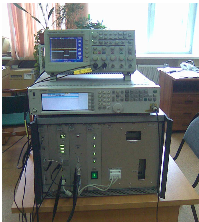
Рис. 2. Проведение испытаний в целях утверждения типа ионозондов «Парус-А»
