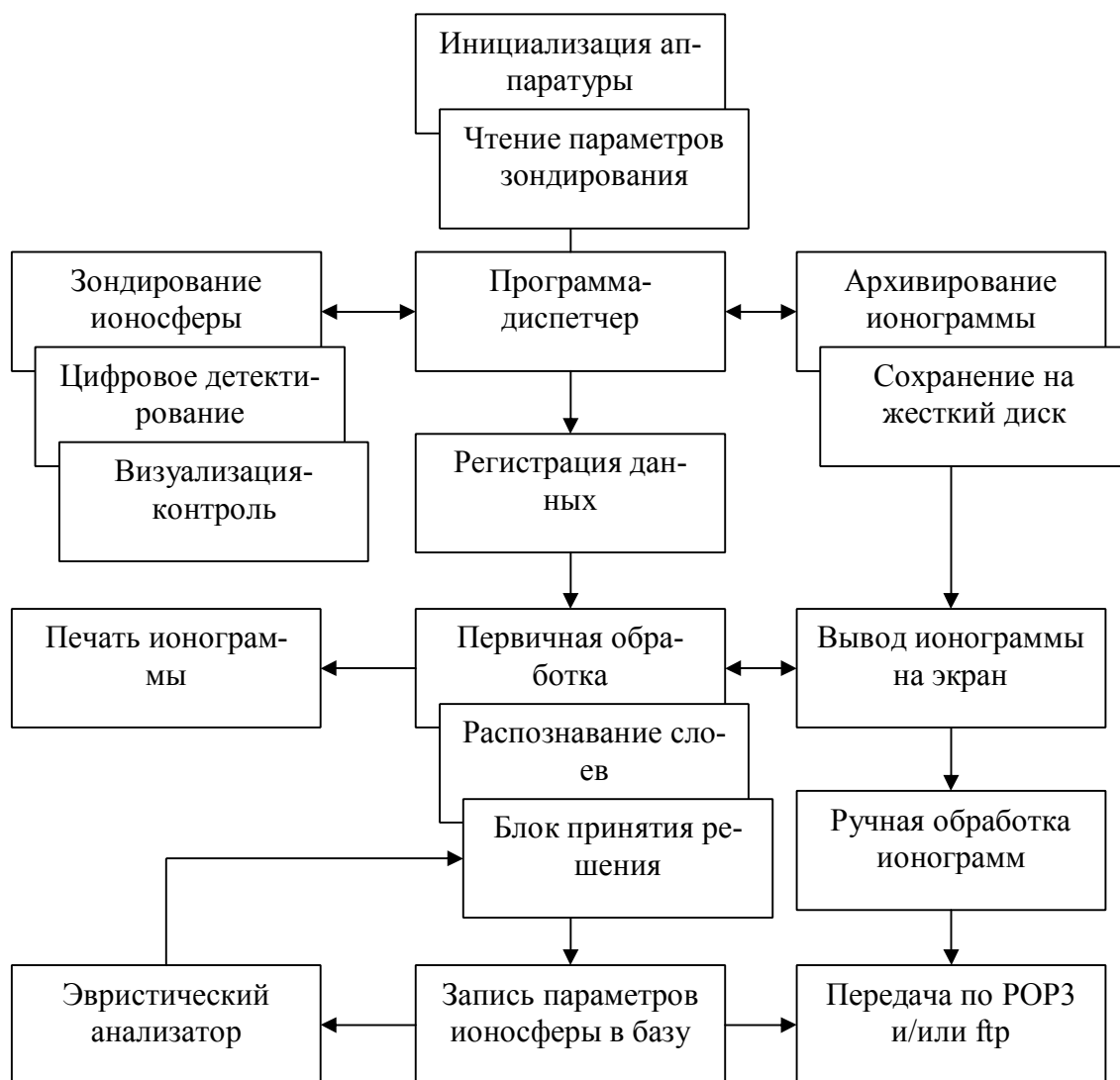
Рис. 2. Структурная схема программного обеспечения ионозондов «Циклон»
