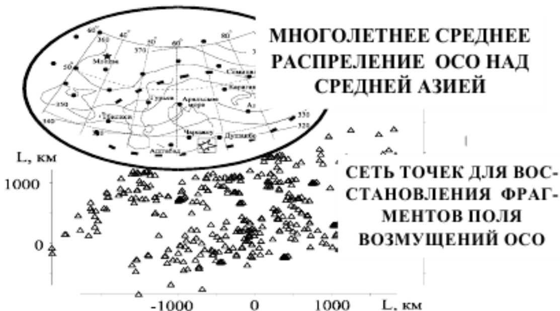
Рис. 2. Сеть точек, использованная для восстановления поверхности возмущений ОСО. На фрагменте с климатическим распределением ОСО отмечен эпицентр обобщенного землетрясения.
