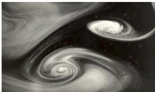
Рис. 8. Преобразование тороидального вихря при его касании поверхности воды.
