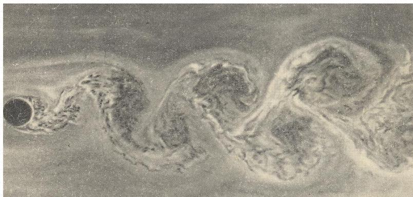
Рис 3. След цилиндра в потоке жидкости в гидродинамическом лотке, подкрашенный алюминиевой пудрой.  $Re \sim 100$  [29].
