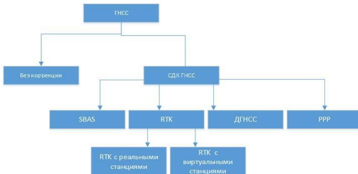
Рис. 1. Схема методов и систем высокоточного позиционирования.
