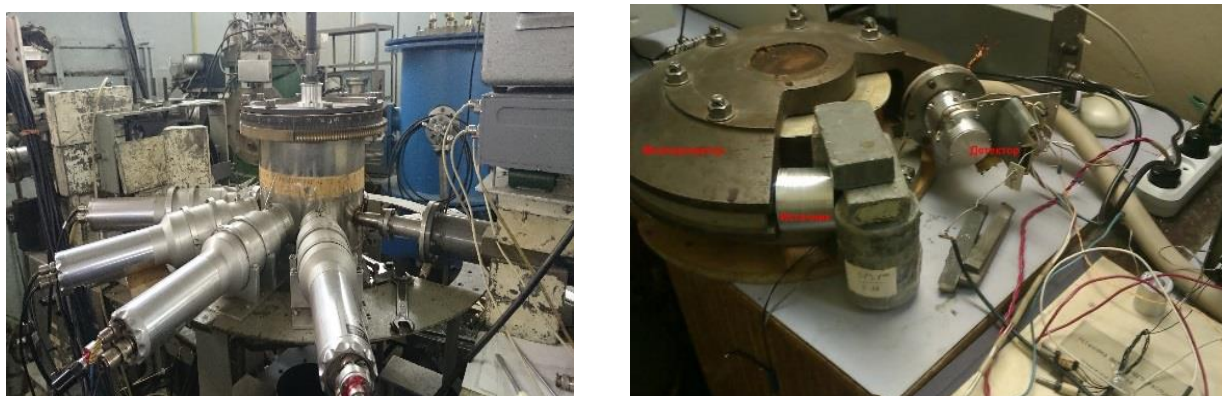
Рис. 3. Протонный ускоритель (циклотрон) У-120 (слева) и переносной ускоритель электронов (монокроматор) ИПГ-626 (справа), подготовленные для калибровки детектора ГАЛС и спектрометра СКЛ.
