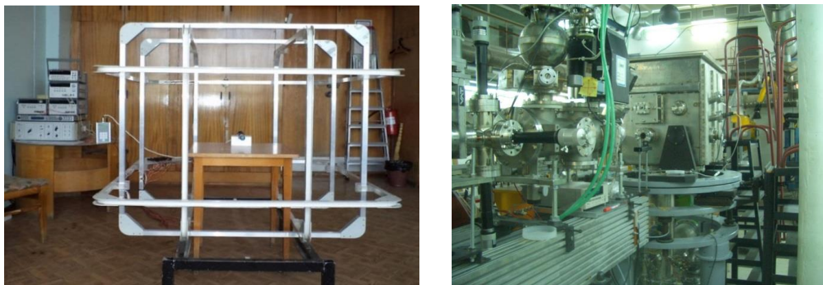
Рис. 2 Установка для воспроизведения единицы магнитной индукции постоянного магнитного поля для калибровки магнитометров типа ФМ (слева). Калибровка измерителя ультрафиолетового излучения Солнца типа ВУСС на синхротроне (справа).
