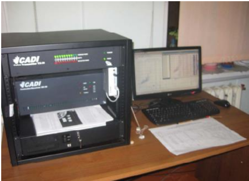
Рис. 2. Рабочее расположение элементов ионозонда CADI на ионосферной станции «Салехард»
