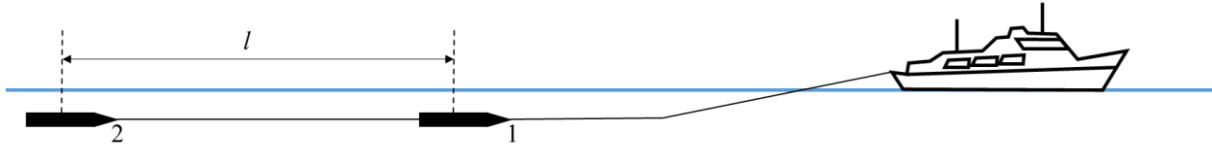
Рис. 1. Принципиальная схема курсового градиентометра с двумя магнитометрическими датчиками
