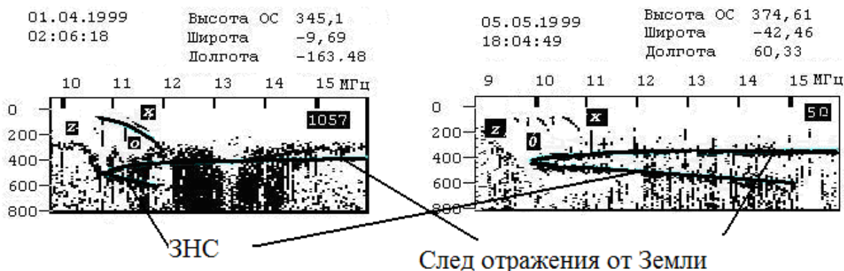
Рис. 1. Ионограммы, полученные с ОК «Мир» с высоты ниже максимума концентрации электронов слоя F2
