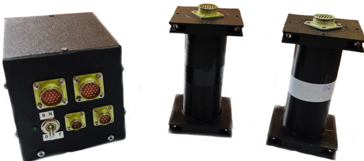
Рис. 2. Магнитометр-градиентометр с двумя феррозондовыми трёхкомпонентными датчиками
