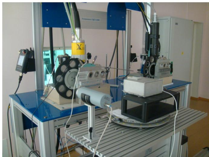
Рис. 9. Рабочее место для калибровки измерителя ДИP-Э по плотности потока фотонов.
