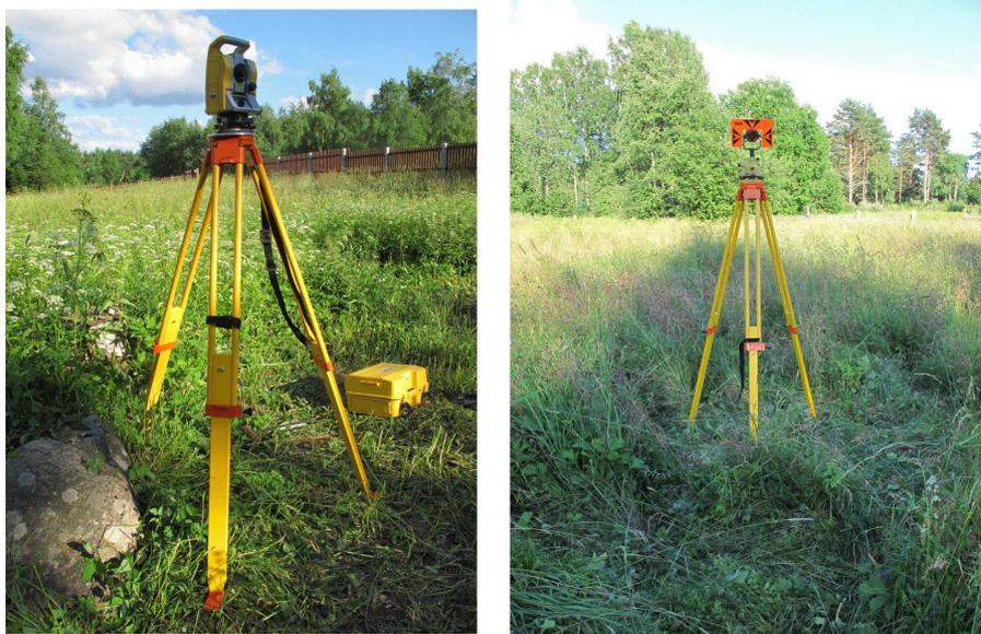
Рис. 4. Электронный тахеометр на пункте 1 (слева) и визирная марка на пункте 2 (справа).
