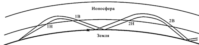
Рис. 22. Схема последовательных отражений от ионосферы и земной поверхности узких пучков радиоволн (приближение геометрической оптики). 1Н - первая нижняя мёртвая зона; 2Н - вторая нижняя мёртвая зона. 1В - первая верхняя мёртвая зона, 2В - вторая верхняя мёртвая зона.
