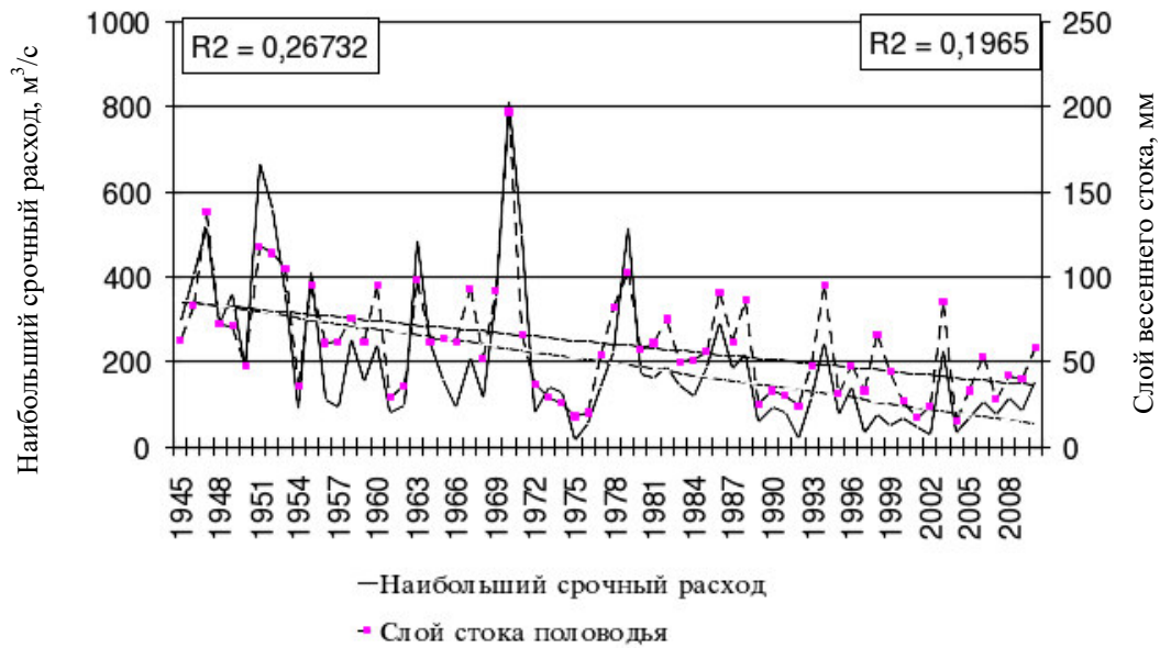
Рис. 1. Динамика многолетних значений наибольшего срочного расхода и слоя весеннего стока для г.п. р. Тускарь - г. Курск
