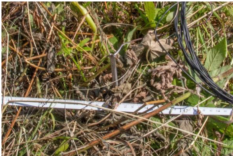
Рис. 7. Внешний вид установленного на местности электрода (видна лишь четверть длины)
