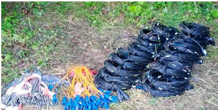
Рис. 2. Комплект оборудования (электроды, провода) из десяти площадных сегментов (макс. шаг по x – 2 м)
