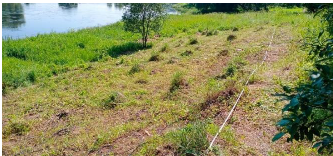
Рис. 6. Внешний вид участка работ после размещения электродов (вид с ЮЗ угла)
