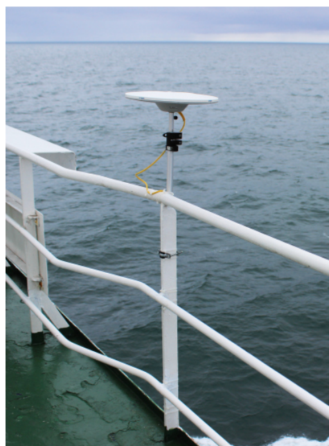
Рис. 2. Навигационный приемник Trimble-5700 и антенна на НИС «Профессор Молчанов» в Карском море, 4.08.2014 г.
