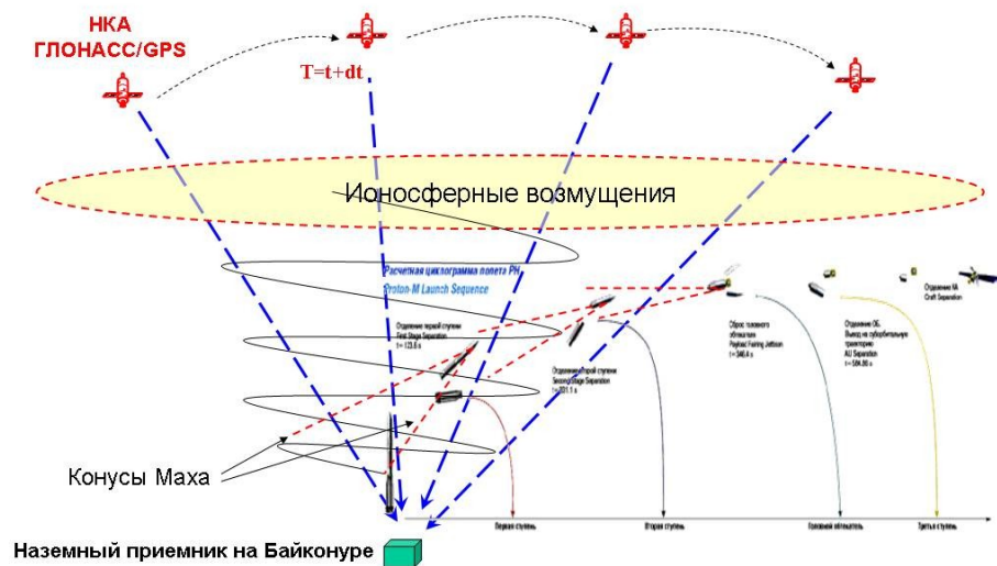
Рис. 1 – Схема эксперимента по зондированию ионосферы над Байконуром.
