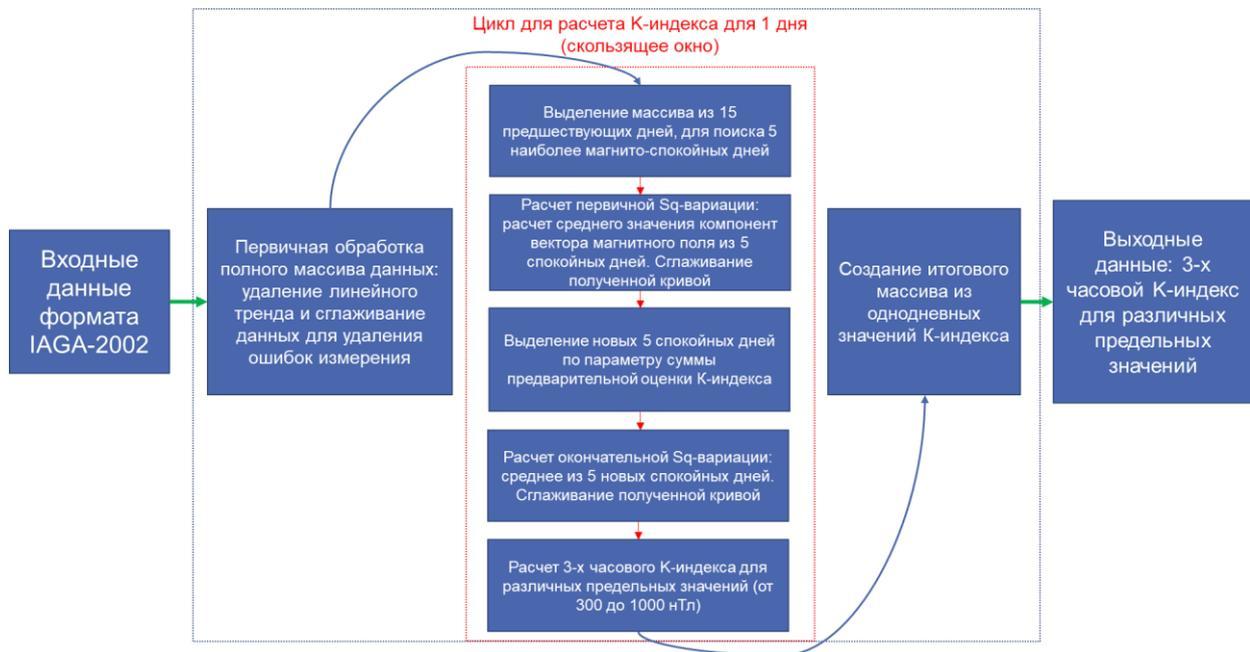
Рис. 3. Схема работы программы для расчета  $K_p$ -индекса
