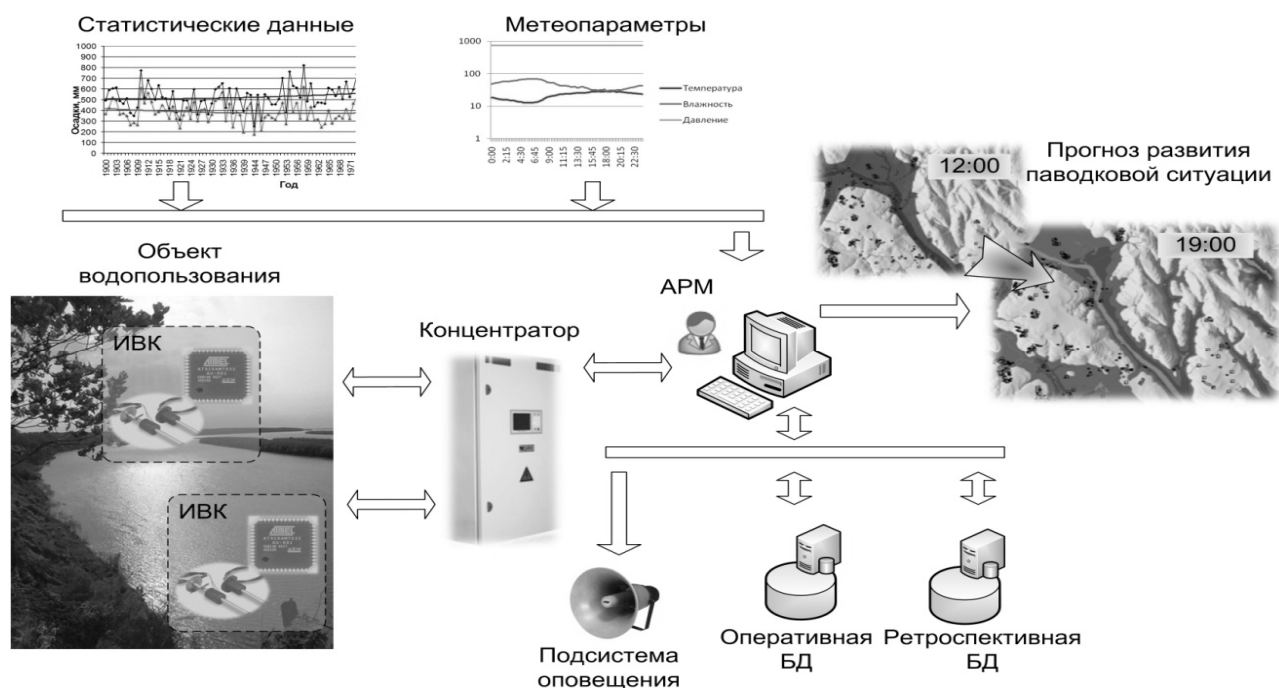
Функциональная схема системы автоматизированного мониторинга гидрологических характеристик и оперативного прогнозирования наводнений и паводков [8]
